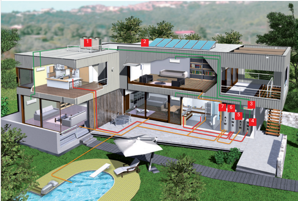
IMPIANTO VRF A RECUPERO DI CALORE CON PRDUZIONE DI ACQUA CALDA
